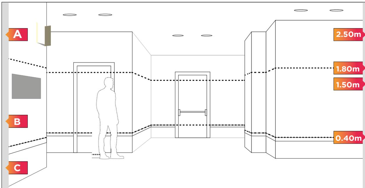
**A** - Señalización en altura. Sirve para señalar los recorridos de evacuación y la localización de los equipos de lucha contra incendio, por lo que debe instalarse entre los 2m y 2,5m, y siempre con una separación mínima del techo a la parte superior de la señal de 30 cm. Así, con las señales instaladas a esta altura se asegura a todos los usuarios de un determinado espacio que la señalización permanecerá visible mimo que haya obstáculos.
