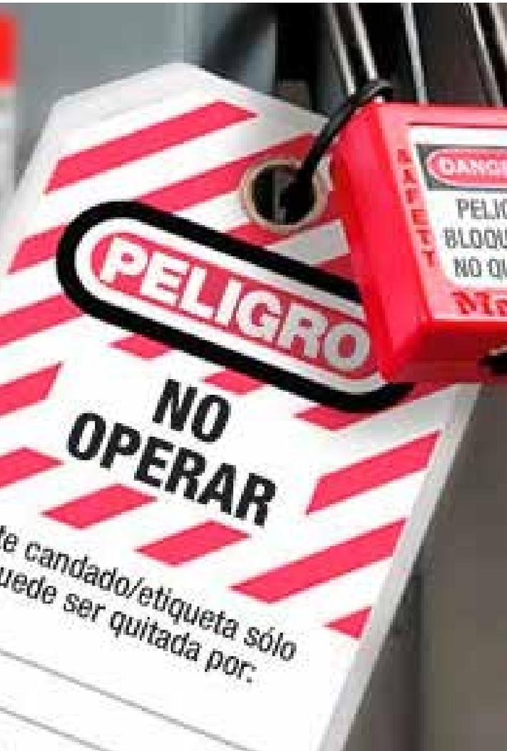
El bloqueo y etiquetado, también conocido como **LOTO (Lock Out, Tag Out)**, es un procedimiento de seguridad que se debe de implementar en cualquier instalación industrial. Con este proceso se garantiza que la maquinaria se encuentra debidamente apagada y bloqueada para realizar los trabajos de mantenimiento y así reducir los porcentajes de accidentes laborales fatales en las industrias.
