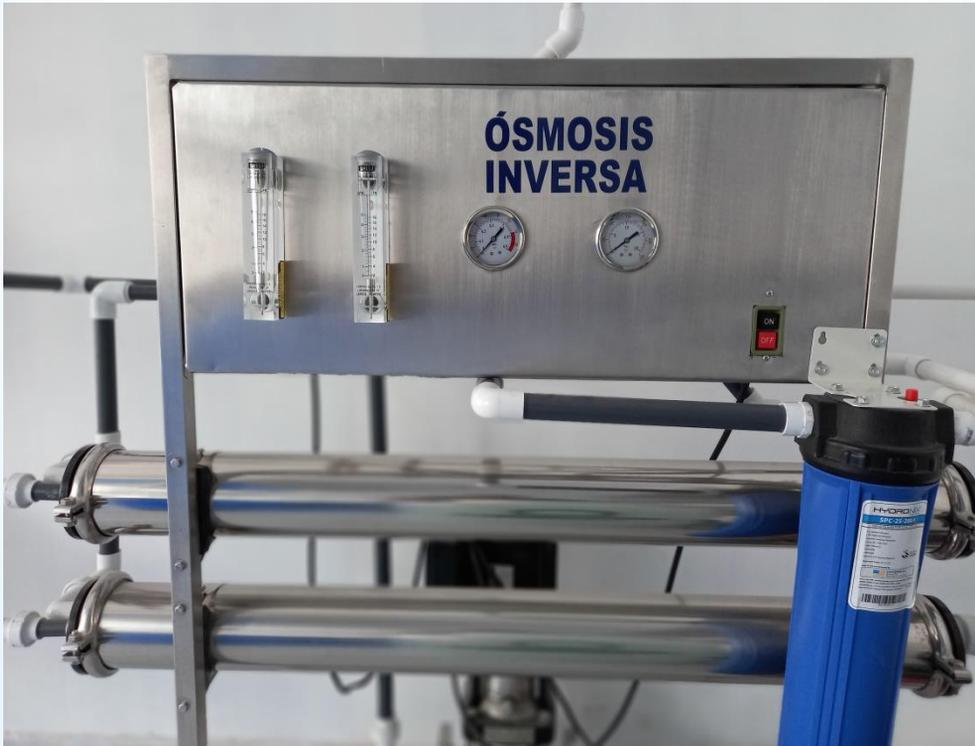
La **ósmosis inversa** es una técnica muy eficiente y competitiva para separar un solvente de los solutos que lleva disueltos, puesto que, aplicada al agua, la membrana permite la separación del 95% de las sales disueltas, lo cual permite la desalinización de aguas salobres o de aguas de mar.
