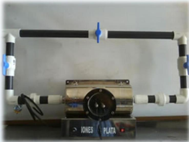
La ionización de plata a través de una descarga eléctrica de 9 volts genera la capacidad oligodinámica de la **plata** permite que al entrar en contacto con el **agua** se liberen **iones** mediante una reacción física llamada oxido-reducción rompen la pared celular de los microorganismos y bacterias logrando una efectiva desinfección.
