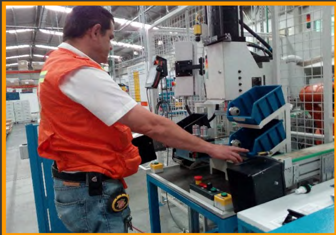
Instalación de sistemas (Pick to light)
