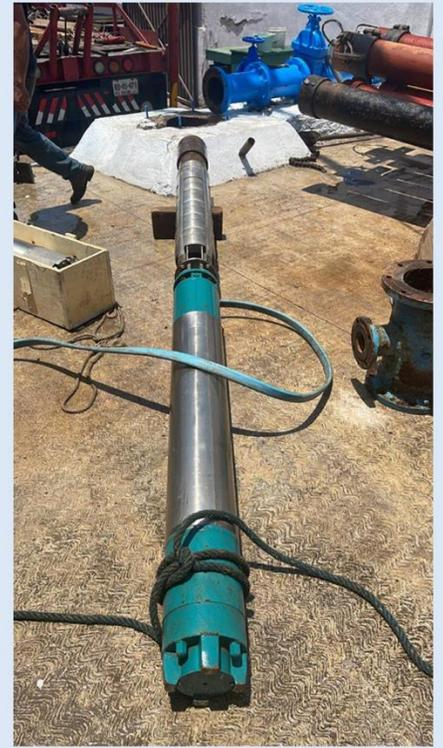
**Suministro e instalación de bombas sumergibles así como mantenimiento correctivo y preventivo**
