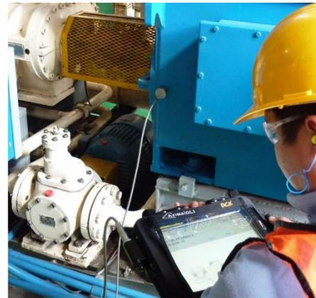
Basándonos en la norma **ISO 10816 – 1995/03** es como se diagnostican los equipos una vez que se ha realizado el análisis de vibración, para que el cliente quede satisfecho de los resultados obtenidos en sus reportes. El equipo **DigivibeMX M30**, es un equipo diseñado específicamente para realizar este tipo de mediciones, incluyendo el balanceo dinámico en dos planos, tanto en el campo como en una
