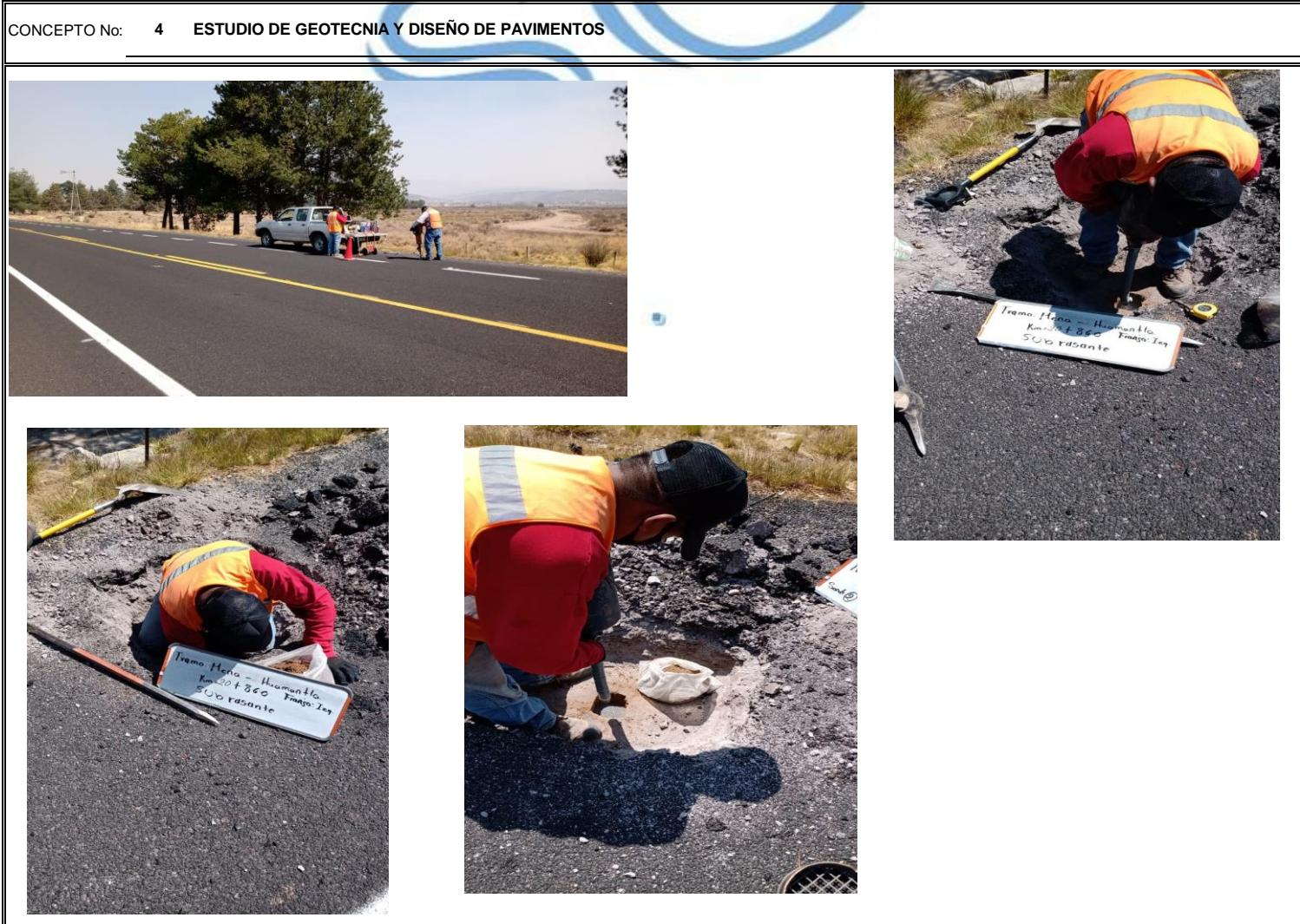
SE OBSERVAN TRABAJOS DE EXTRACCION DE MUESTRAS DEL SUELO Y DE LA ESTRUCTURA DE L PAVIMENTO EXISTENTE
